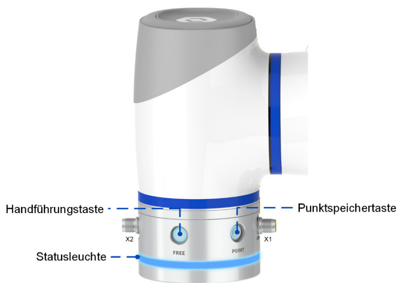
Abb. 2.1 Werkzeugflansch-Tasten und -Statusleuchte (CR20A/CR20AF/CR30A)
