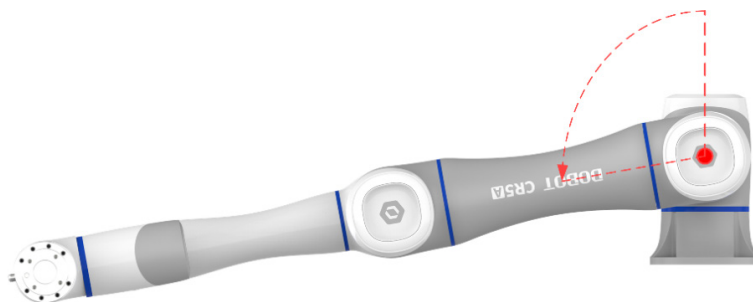
Abb. 3.5 Not-Halt-Test für Achse J2
